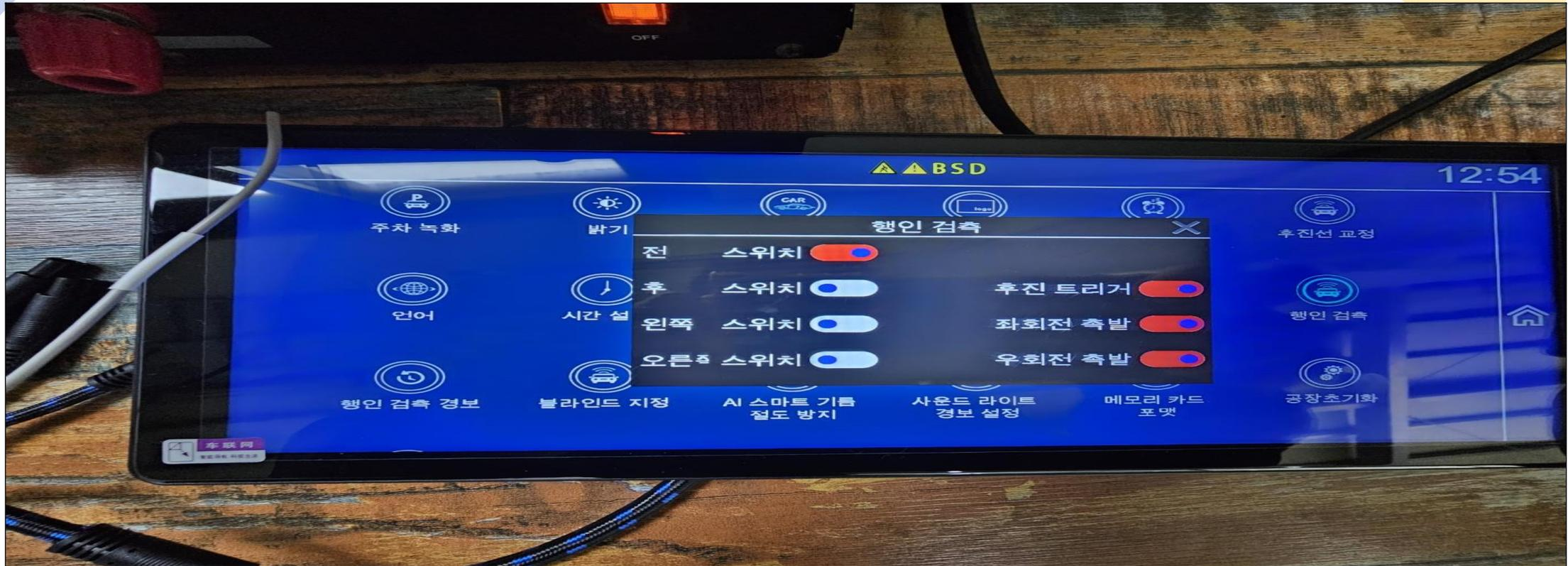
\* 현재 한국특수가스 BSD 4CH 개체 인식 사양에 전방은 상시 행인검측 으로 설정되어 있으며 후방 왼쪽 우측은 트리거 신호시에만 개체인식을 하게되어 있습니다. 설정 방법은 좌측에 있는 행인검측 스위치를 빨강표시로 설정시 상시로 경고음 발생이며 트리거 신호시 에만 설정을 원할시 스위치를 끄고 우측에 트리거 신호에대한 설정을 켜주시면 됩니다.
