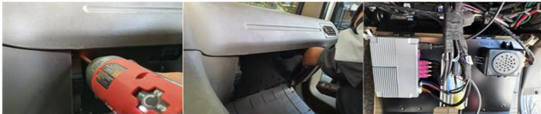
[그림] 어라운드뷰 단말기 장착 위치 및 볼트 탈거 위치
